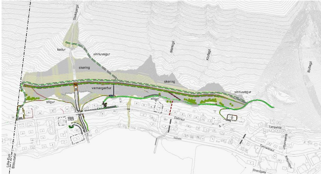
Mynd 2. Lega vinnuvega og slóða vegna ofanflóðavarna á Bildudal. Á myndinni eru vegir og slóðar sýndir grænir.
